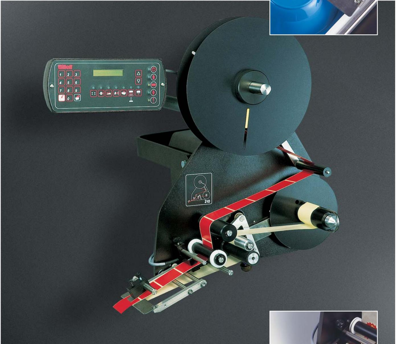
A Willett 210 é uma aplicadora de etiquetas industrial, moderna e possui controle microprocessado. Um motor de passo traciona o desbobinamento da etiqueta a uma velocidade de até 30 metros por minuto. Métodos de aplicação opcionais incluem o módulo pneumático e jato de ar.
